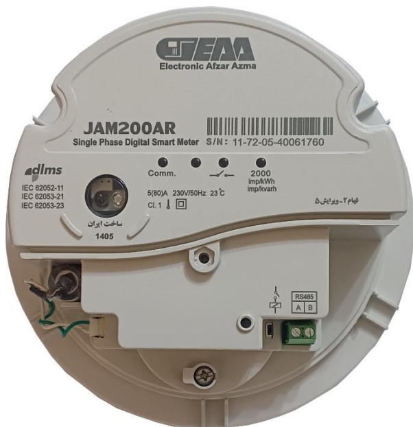
شکل ۷: محل قرارگیری باتری خارجی در کنتور JAM200AR (پوشش باید شکسته شود)
